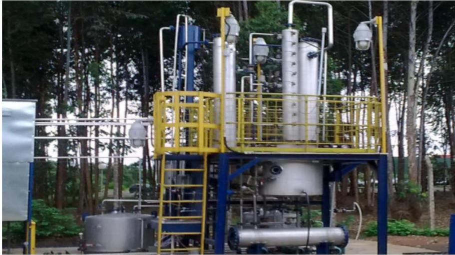
Fig 1. Planta piloto para recuperação de solventes orgânicos
